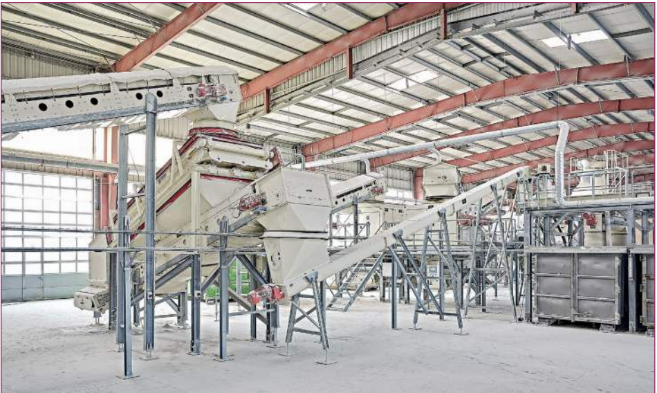
Bild 2: Aufbereitungsbereich mit Zerkleinerungs- und Klassierungstechnik
