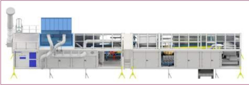
Bild 3: Darstellung der geplanten automatischen sensorgestützten Sortieranlage
